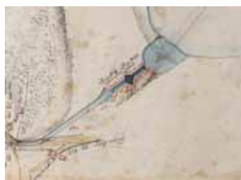
Detalkort med kammerlusen ved Jægersborg og Kanalforløbet ved Ermelundsvej. Niveaueændringen var her 8 fod (2,4 m), der skulle klares ved to sluser med højdeforskelle på 4 fod. Nord til venstre. Det kgl. bibliotek.
